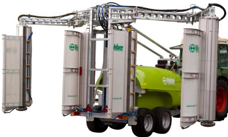
WEBER – descentes avec panneaux récupérateurs
